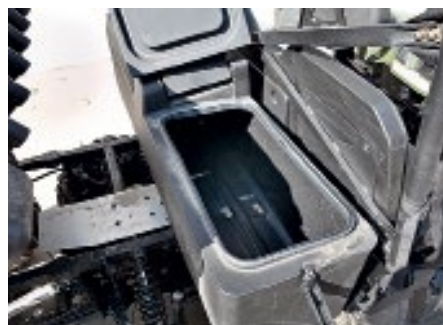
Две огромные герметичные емкости между кузовом и сиденьем в базовой комплектации
