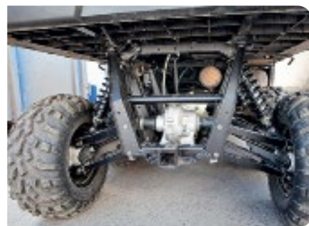
Независимая подвеска сглаживает работу тяжелой 4-колесной тележки
