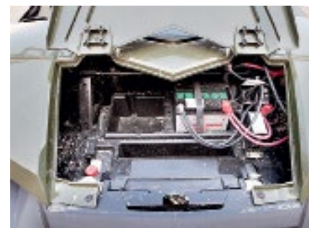
Аккумуляторный отсек рассчитан на установку дополнительной батареи
